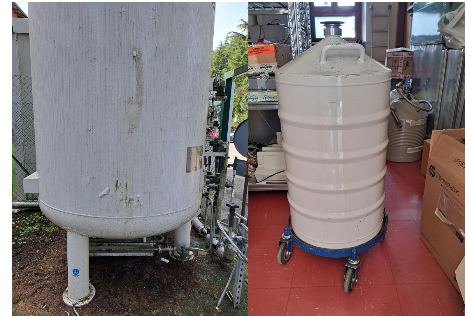
Riempimento Dewar per NMR dall'erogatore esterno dell'evaporatore criogenico
