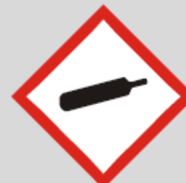
Gas in pressione Gas liquefatti Gas disciolti
